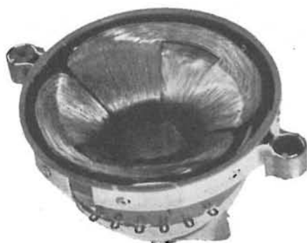
Fig. 4.7. - Giogo di deflessione con le bobine della figura precedente.
