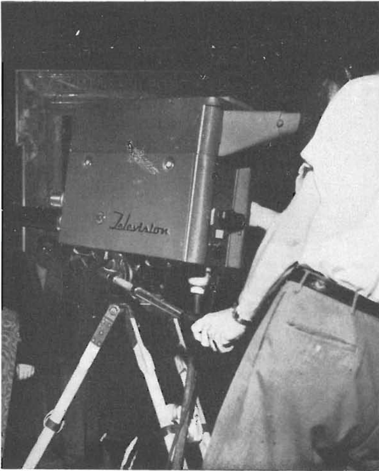
Fig. 5.6. - Nell'interno della telecamera si forma l'immagine elettrica della scena da trasmettere. Dall'immagine elettrica ha inizio la trasmissione televisiva.
