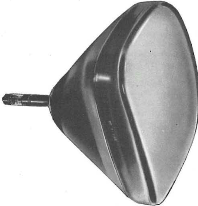
Fig. 4.1. - Tubo catodico a deflessione elettromagnetica da 21 pollici, con schermo utile di 46 cm di base e 35 cm di altezza. Funziona con tensioni anodiche al secondo anodo di 16 000 V.
