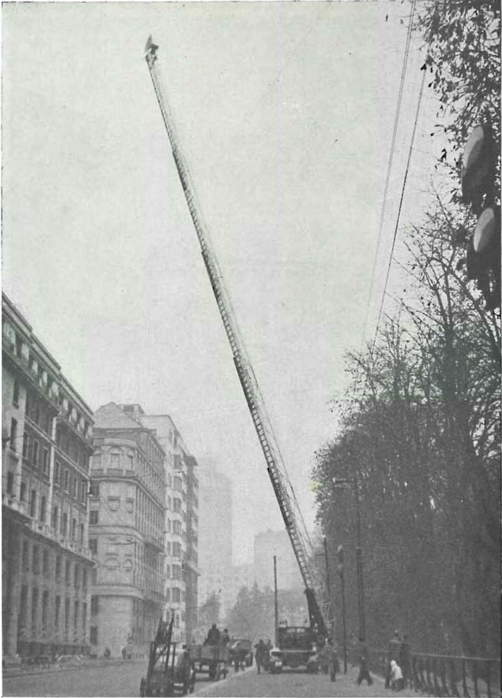
Fig. 18.19. - Antenna posta sull'estremità di alta scala, per ottenere il ponte radio con la trasmittente, durante una ripresa esterna, dallo Zoo di Milano.
