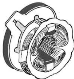
Fig. 4.4. - Giogo di deflessione, con le bobine orizzontali e verticali, da infilare sul collo del cinescopio.
