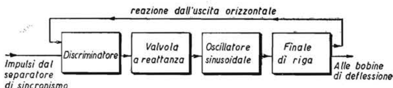
Fig. 13.24. - Schema a blocchi del circuito CAF con valvola a reattanza.
