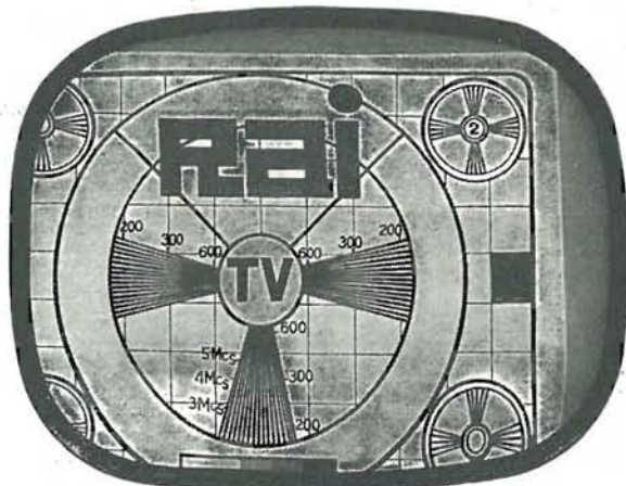
Fig. 6.20. - Immagine fuori centro per errata posizione del dispositivo centratore.
